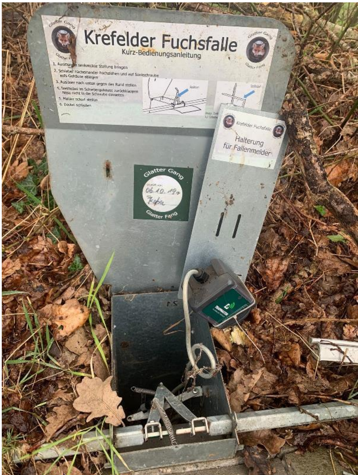
Abb.5) Offene Abdeckplatte des “Elektronischachtes“ mit Halteblech für den Fallenmelder!
