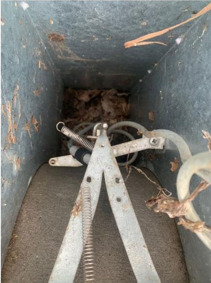
Abb.3) Blick in den "Elektronischacht", oben der Auslösemechanismus und darunter die Abreißkupplung!
