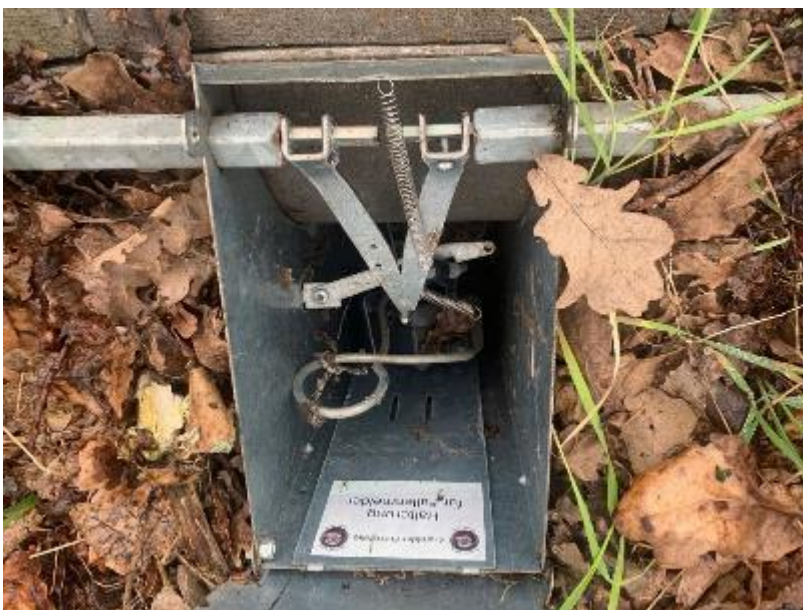
Abb.3) Blick in den "Elektronischacht", oben der Auslösemechanismus und darunter die Abreißkupplung!
