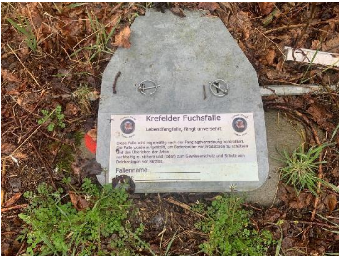
Abb.1) Abdeckplatte der in den Boden eingebauten Krefelder Fuchsfalle unter der sich auch der Fallenmelder befindet.
